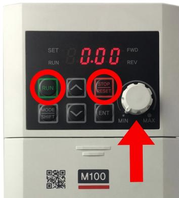
Drehen Sie das Einstellrad im Uhrzeigersinn um die Geschwindigkeit zu erhöhen oder im Gegenuhrzeigersinn um sie zu senken.
